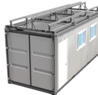
Les poutres du cadre sont adaptées aux dimensions standard des panneaux photovoltaïques, et les pieds sont compatibles avec les toits des conteneurs standards. L'ajustement permet une largeur de 2440 ou 3000 mm, avec une longueur de 6050 mm. Il peut être utilisé sous forme monopente ou bipente.
