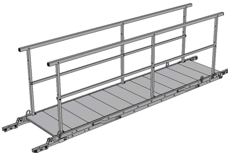
Rys 3. Treppe im zusammengefalteten Zustand als Steg
